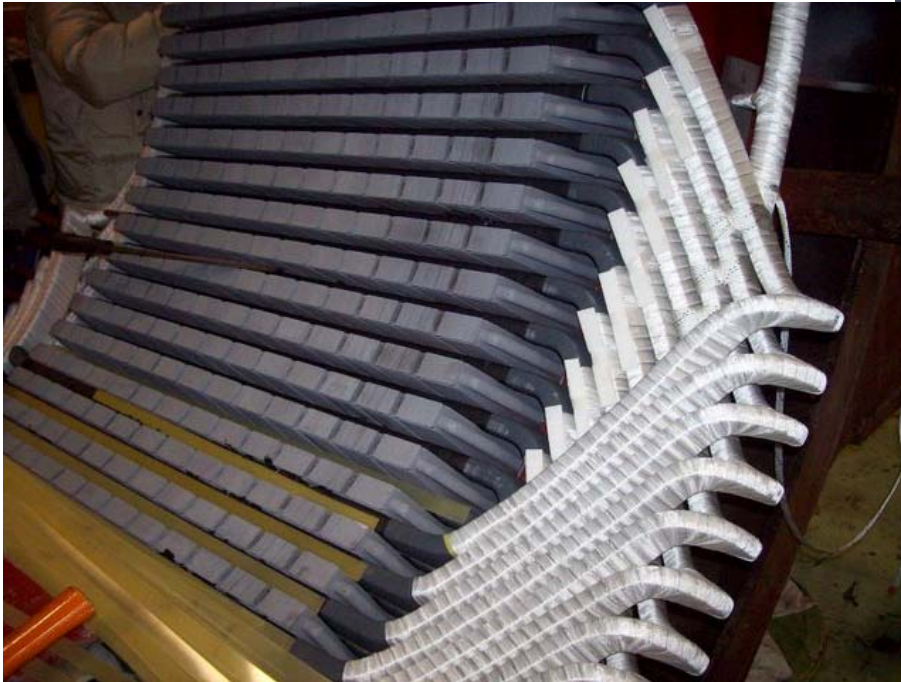
Statore di un alternatore di centrale idroelettrica.
