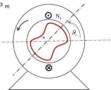
La macchina può essere schematizzata come un avvolgimento concentrato lungo l'asse avvolgimento di statore, mentre la direzione del rotore è individuata da un asse d in moto rispetto allo di statore.
