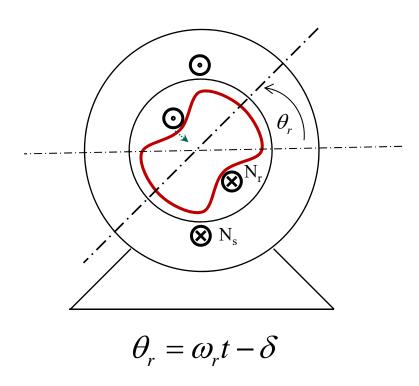
Una delle strutture è in generale anisotropa (rotore)
