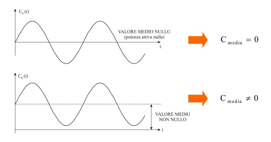
Nel caso di <u>statore cilindrico e rotore a poli salienti</u>, l'espressione della **coppia** istantanea C<sub>e</sub>(t) è:
