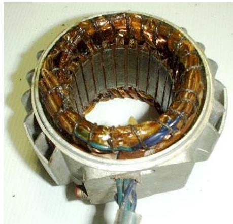
Avvolgimenti di uno statore trifase (distribuiti)
